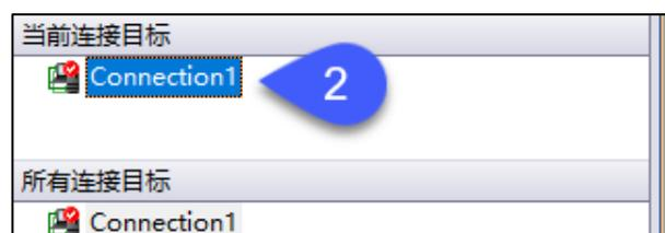
在连接目标选项卡中设置/确认连接方式，并点击“通讯测试”按钮，若弹出成功连接的通知框，即表明通讯成功建立了。
