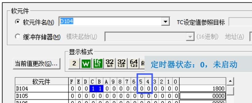
(7) 当 Q\_low\_Timer 状态值为 1 或 2 时, 若 D2M 的流量 (D101 中的实时数据) 大于 “自动控制流量值 (Auto control low flow limit)” (示例中为 100l/min), 而 Am0.5=0 (即截止阀自动使能为 0), Q\_low\_Timer 将被重置, 模块恢复至正常生产状态。
