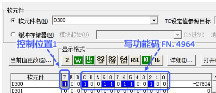
(3) 诊断接口的输入字格式如下，在输入字区 D100 中，可以查看调用的功能码结果。如果诊断输出字的控制位复位，则输入反馈也将清除。
