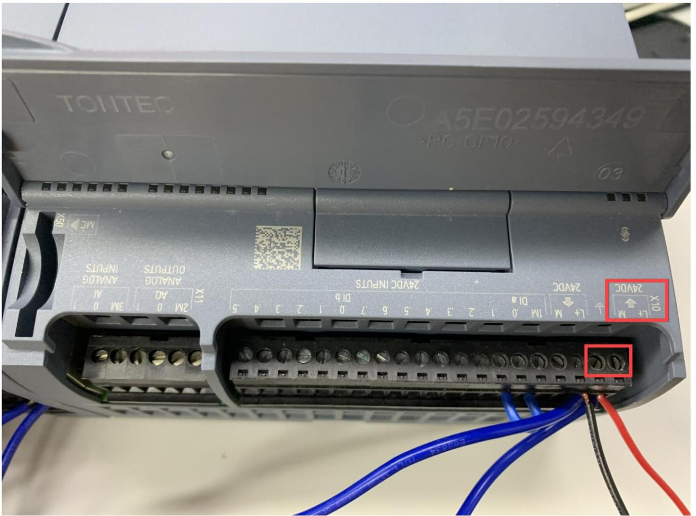
图 PLC 供 24V 电接线
