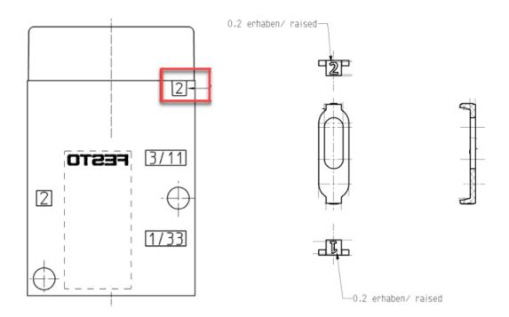
阀体上密封垫显示"1",则表示 MFH/VL 阀体上密封垫显示"2",则表示 MOFH/VLO
