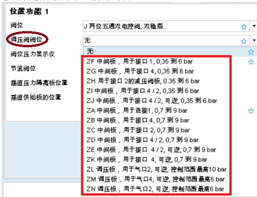
在 VTSA 阀岛选型软件中选择减压阀板后，还可以在如下选项中选择是否带锁和是否加长减压阀。加长减压阀的目的是为兼容第三方 ISO 电磁阀片的安装。因为 VTSA 的电磁阀座符合 ISO 标准，其他符合 ISO 标准的电磁阀也可以安装到加长减压阀板上。另外，还需要对压力表的规则作选择。选型界面如下图：
