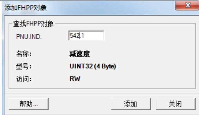
添加好后点确定，可以看到 FPC 占了 8 个字节 FHPP+用了 8 个字节（本实例中 FPC 参数通道勾选上了，如果不用到此功能，也可不勾选，相应的 FPC 组态也可删除掉），FHPP+数据加速度和减速度分别占用 4 个 byte，共 8 字节
