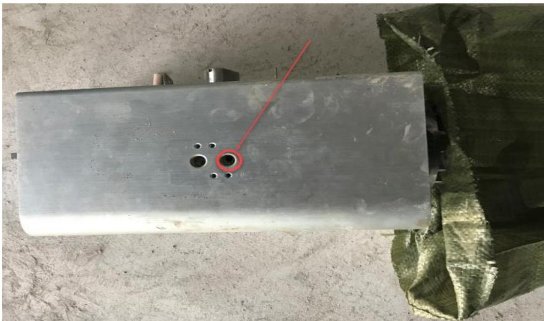
图2 加压推动驱动头内部活塞
