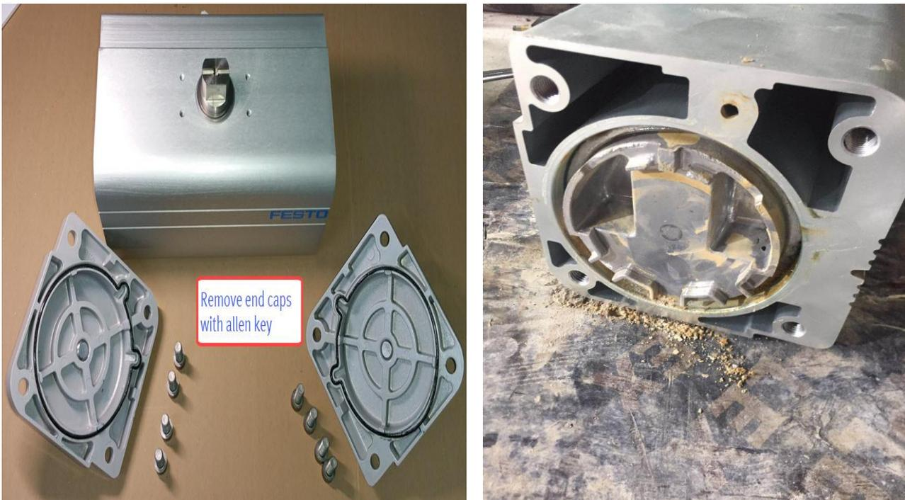
图 1 驱动头拆开两个端盖
