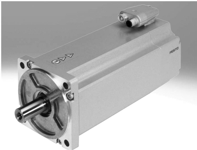
EMME-AS 电机编码器是数字量绝对值位移编码器，采用电容式测量原理，单圈编码器分辨率为 9 位，多圈编码器分辨率为 9 位，圈数为 4096 圈。
