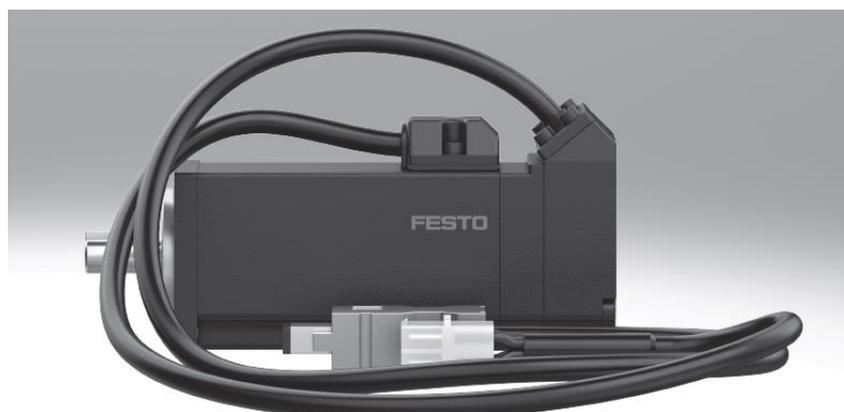
EMMB-AS 电机编码器是数字量绝对值位移编码器，采用光电式测量原理，单圈编码器分辨率为 20 位，多圈编码器分辨率为 20 位，圈数为 65536 圈。
