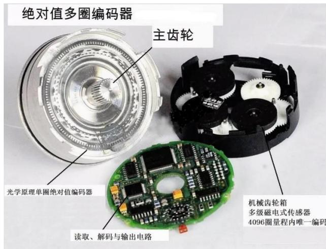
机械绝对计圈的编码器每圈位置和圈数都是绝对值，现在常见的是 4096 圈和 65536 圈两种。
