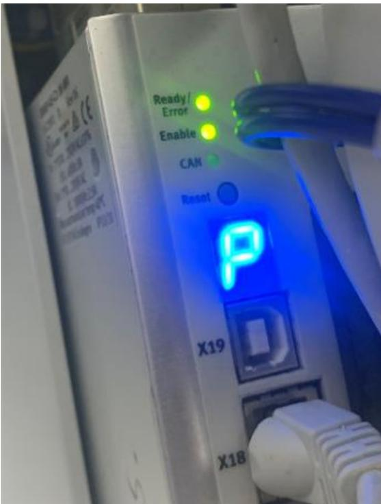
七段码显示 P 开头，表示处于定位模式，状态正常。如果显示 E 开头则表示 Error，需要检查伺服。
