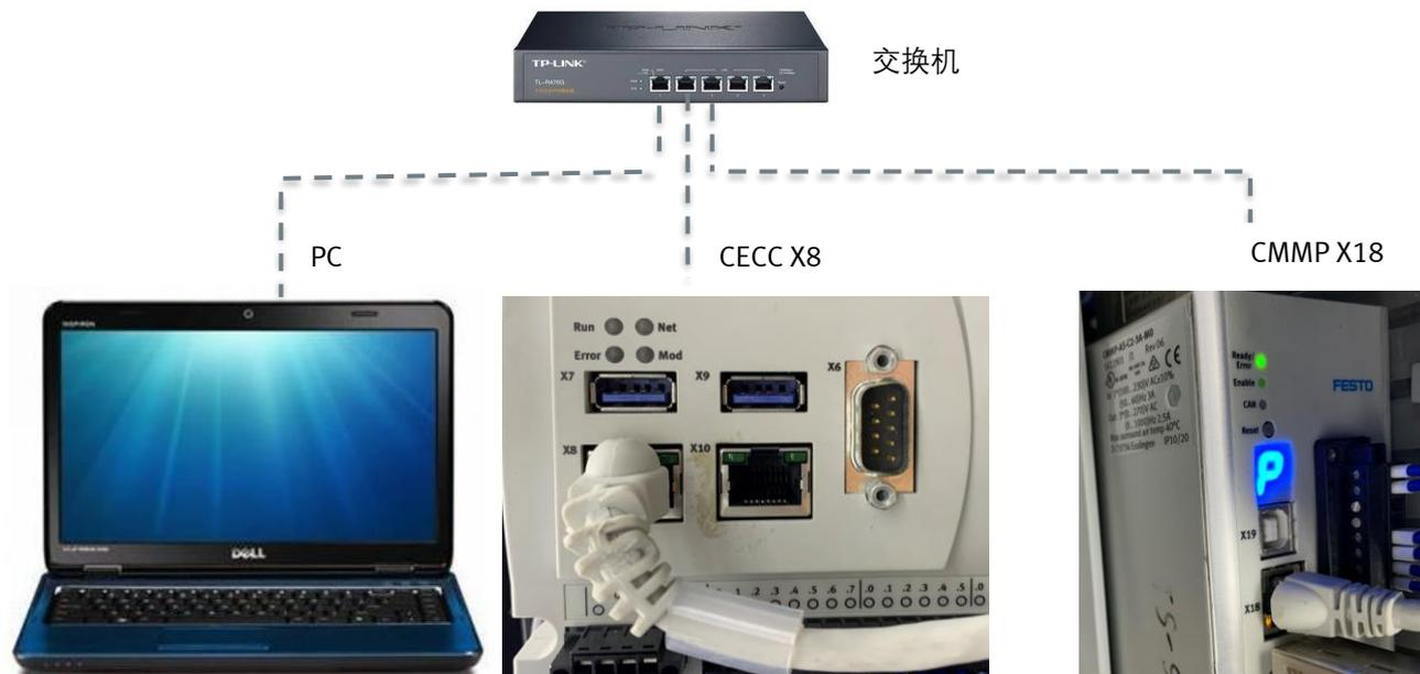
Festo Field Device Tool 可以执行 Festo 以太网设备的网络扫描、固件更新等功能。
