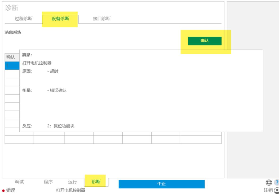
通过“诊断”->“设备诊断”页面的“确认”按钮可清除故障状态。
