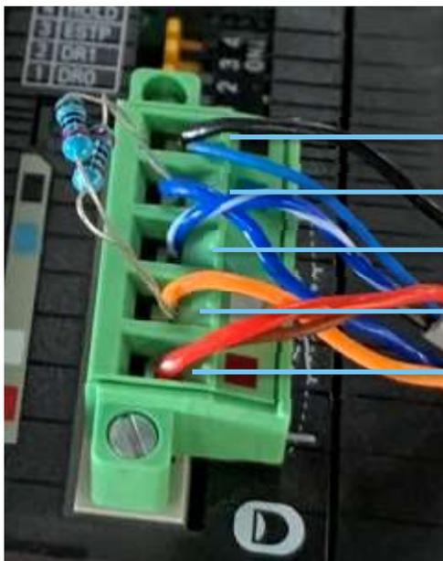
0V，此处需要外部接入 0VDC 电源，注意有两条线
