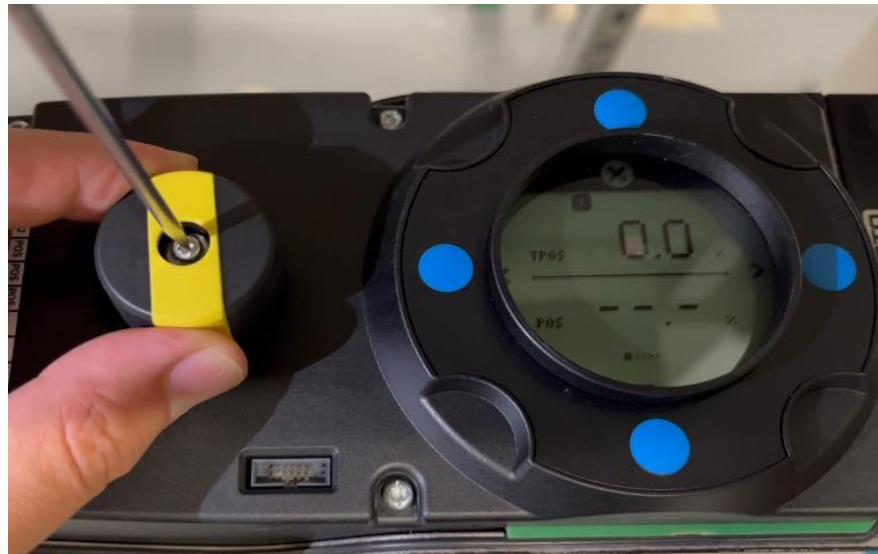
C. 经过调整后使其在 min----max 之间的条形黑色粗线变化，在一个完整线性周期内，同时屏幕上一直显示“小扳手”图标，无错误信息提醒，如下图。
