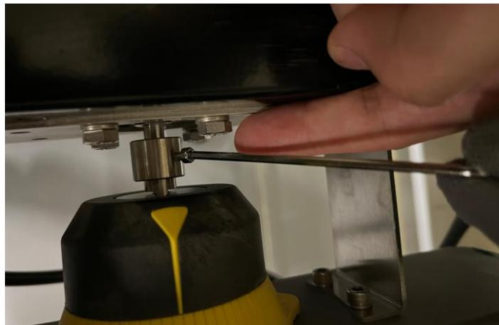
B. 用一字螺钉压紧指示器内的螺钉，带动出轴端一起旋转，同时观察显示屏，使得传感器在打开和关闭的范围内均未出现错误报警图标。
