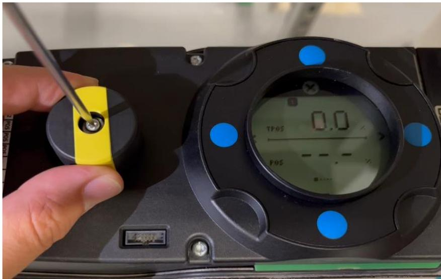
C. 经过调整后使其在 min-----max 之间的条形黑色粗线变化，在一个完整线性周期内，同时屏幕上一直显示“小扳手”的图标，无错误信息提醒，如下图。
