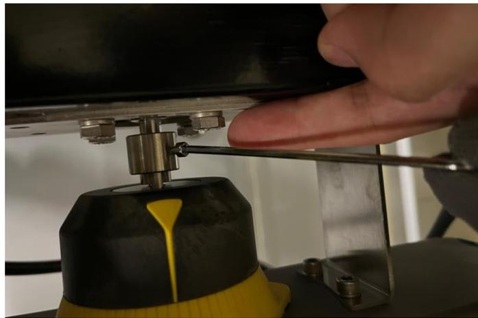
B. 用一字螺钉压紧指示器内的螺钉，带动出轴端一起旋转，同时观察显示屏幕，使得传感器在打开和关闭的范围内均未出现错误报警图标。
